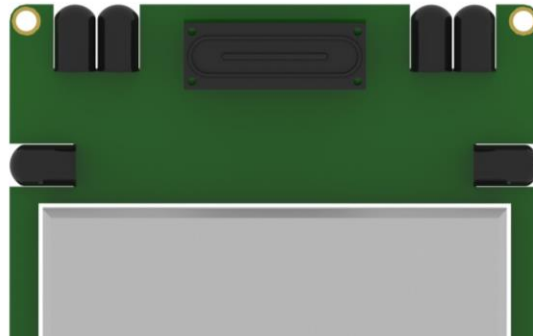
Figur 14. Visar placeringen av högtalaren på kretskortet.
